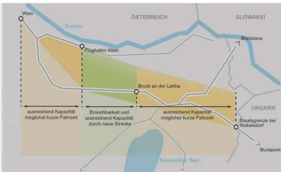
Das angestrebte Neubauprojekt ermöglicht, die bestehende Ostbahn zu entlasten und zusätzliche Regionalzüge ohne einen Zeitverlust gegenüber der alten Ostbahn über den Wiener Flughafen zu führen. Die neue Ostbahn bringt zudem auch eine Entlastung für den Güterverkehr.
