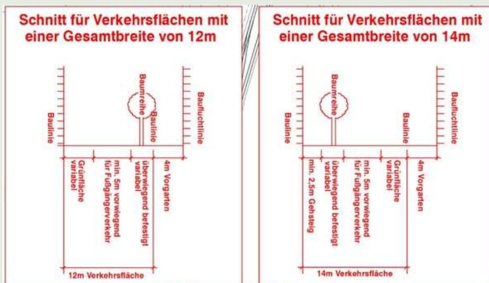
**Abbildung 50: Regelquerschnitte für die Straßenfreiräume im Nordosten der Seestadt Aspern. Ausschnitt aus dem Flächenwidmungs- und Bebauungsplan Plandokument 8071/2 (Quelle: Stadt Wien - MA21, 2015)**
